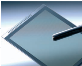
Lasergeschnittenes TFT Display für Handys
